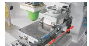
Movimiento de la plataforma entrada/salida (limpieza del tampón por debajo)
